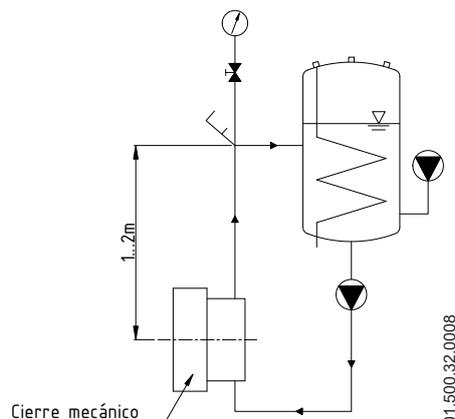
Il est recommandé que les tuyauteries du liquide auxiliaire soient en acier inoxydable et qu'elles soient aussi courtes et droites que possible afin que le liquide auxiliaire puisse circuler facilement.
